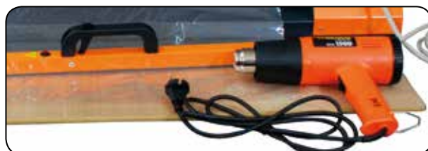
Generatore di aria calda (a due velocità) Two speeds hot air generator
